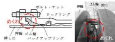
図 接合不良の例
